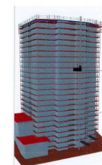
1 VISUALISATION DE L'ÉCHAFFAUDAGE ENTOURANT L'ENSEMBLE D'UN BATIMENT
